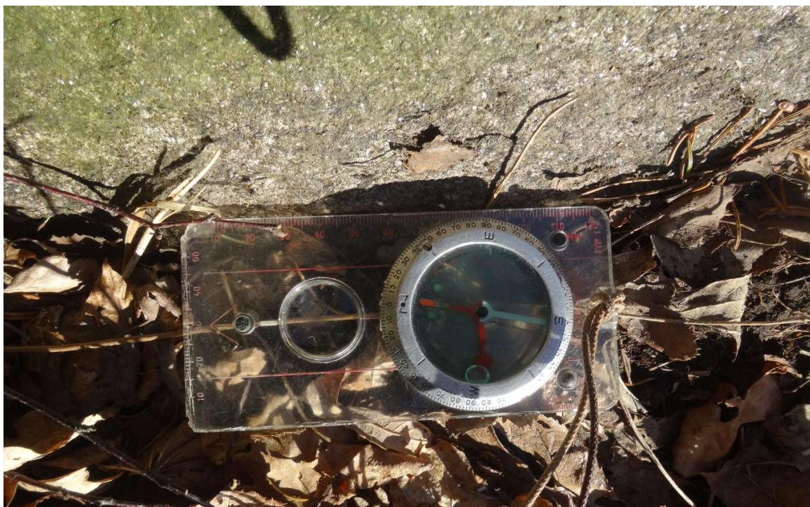
Bild 4 där kompassen har lagts med samma riktning som foliationen N10^{\circ}W och lutningen var ca 70^{\circ} grader mot väster. Generellt variera lutningen på sprickorna som skapats av foliationen mellan ca 45^{\circ} - 70^{\circ} grader.
