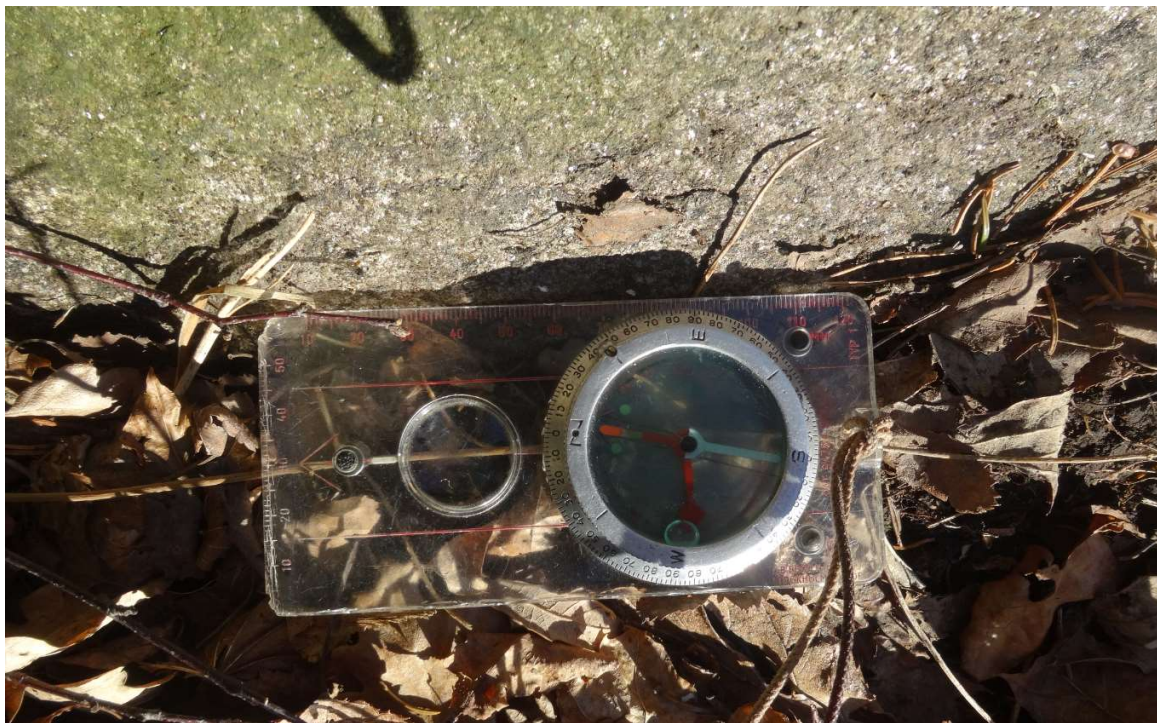
Bild 4 där kompassen har lagts med samma riktning som foliationen N10°W och lutningen var ca 70° grader mot väster. Generellt variera lutningen på sprickorna som skapats av foliationen mellan ca 45°-70° grader.
